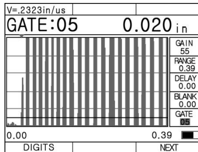
图 3.11 用 PT04 探头测薄板的波形图
