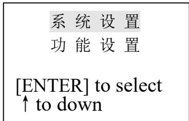
此时，光标在“系统设置”项上，(如果不是在此项上可用△或▽键上下移动将光标移在“系统设置”项上)，按回车键进入系统设置菜单，用△或▽键上下移动选择需修改项，然后按回
