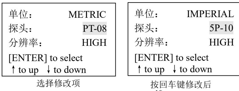
注：UM-2 及 UM-2D 提供多种探头选择功能，为了使测量数值误差小，当使用什么型号探头时，要在探头里的选项选择对应的型号。
