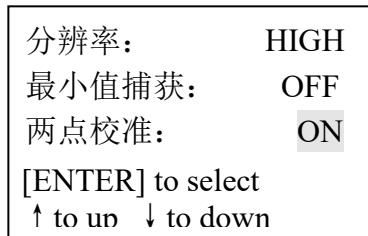
②设置完毕后，按 MENU 键返回主界面。如果两点校准被设为 ON，那么在测量的状态下可随意进行两点校准。
