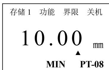
**说 明：** 启用最小值捕获后，探头与工件耦合时，屏幕显示的是当前测量值；当探头抬起时，屏幕显示的是测量中的最小值，并且最小值标志 MIN 闪烁 6 次。如果在 MIN 闪烁期间继续测量，当前测量值将继续参加最小值捕捉，如果 MIN 停止闪烁后再进行测量，将重新捕捉最小值。
