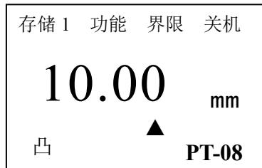
**说 明：** 当探头与被测材料耦合时，屏幕上将显示“凸”标志；当耦合标志闪烁或不出现则说明没耦合好。拿开探头后，厚度值保持不变，耦合标志消失。见下图：
