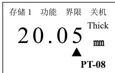
测量厚的标准试块，同样通过△或▽键将测量值调整到标准值，再按 CAL 键，完成校准操作，就可以进行测量。
